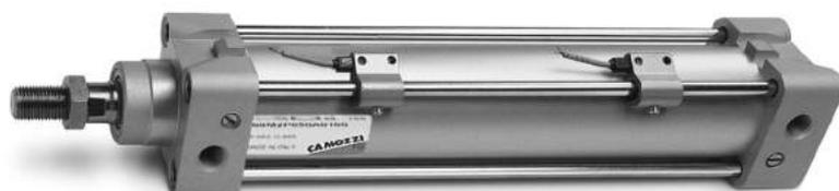
I cilindri Serie 60 sono stati realizzati rispettando gli ingombri delle norme ISO 15552. Sul pistone dei cilindri è alloggiato un magnete permanente che rende possibile, attraverso i sensori disposti lungo l'asse di scorrimento dello stelo, l'emissione di segnali elettrici che ne indicano la posizione.
