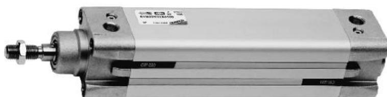
I cilindri della Serie 61 sono stati realizzati rispettando gli ingombri delle norme ISO 15552. Sul profilo sono ricavate, su tre lati parallelamente all'asse di scorrimento dello stelo, le cave per applicare e posizionare i sensori a scomparsa per il rilevamento della posizione del pistone. Queste cave possono essere coperte con un profilo copricava.
