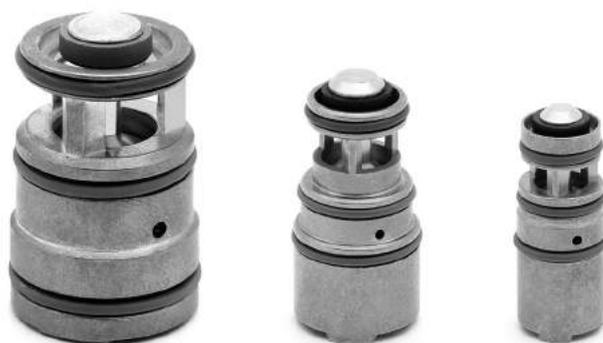
Le valvole a comando pneumatico Serie 8 sono ideali per quelle applicazioni dove viene richiesto un alto flusso combinato ad un design compatto. Il comando pneumatico è dato da elettropiloti dimensionati in funzione della taglia. L'esecuzione a cartuccia, ideale per montaggi in manifold, permette la riduzione degli ingombri e del numero di connessioni pneumatiche.
