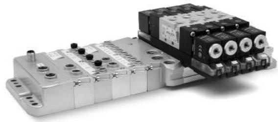
La Serie 3 versione Seriale Individuale si interfaccia tramite un apposito modulo con il modulo multi-seriale Serie CX, nelle sue varianti di protocolli di comunicazione (PROFIBUS-DP, DeviceNet, CANopen, EtherNet/IP, EtherCAT, PROFINET). Anche la versione Seriale, come quella Multipolare, consente di creare isole con 22 bobine su 22 posizioni valvola, con l'aggiunta di un'ampia gamma di moduli elettrici, come ingressi ed uscite digitali ed ingressi ed uscite analogici sia da 0-10 V che 4-20 mA.
