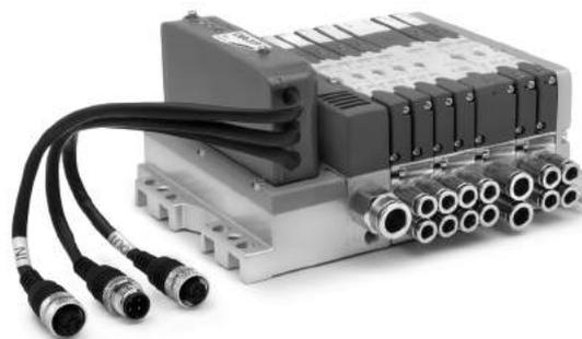
La versione Multipolare può essere collegata in modo rapido e sicuro grazie alla connessione elettrica tramite cavo precablato a 25 o 37 pin con connessione in linea o angolare. È possibile creare zone con alimentazione elettrica differenziata e con pressione/scarico separate. Grazie alle sottobasi con scheda monostabile si possono realizzare Isole fino ad un max di 24 bobine su 20 pos. valvola con la connessione a 25 poli e 32 bobine su 28 pos. valvola con la connessione a 37 poli.
