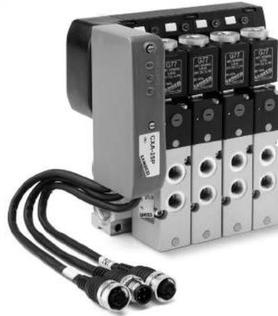
Nella versione Multipolare il collegamento è facilitato grazie alla posizione frontale del connettore Sub-D a 25 poli. I connettori con cavo pre-cablato, disponibili in diverse lunghezze e con orientamento assiale o radiale, agevolano il collegamento elettrico. L'Isola può essere configurata fino ad un max. di 22 bobine con l'uso di moduli elettrici monostabili e bistabili, su 22 posizioni valvola, ad esempio 22 Ev. Monostabili.
