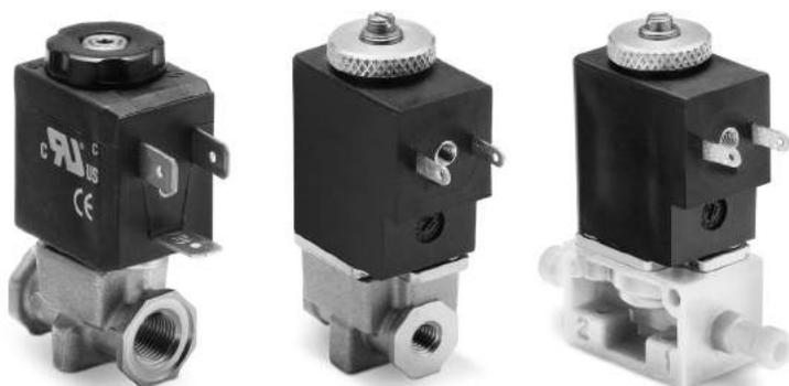
Le elettrovalvole proporzionali ad azionamento diretto 2/2 vie NC, con orifici da 0.8 a 2.4 mm, possono essere utilizzate dove è richiesto un controllo della portata ad anello aperto, in ambito di miscelazione di gas, controllo di flussi liberi o soffi e per il controllo dello svuotamento di camere per mezzo del vuoto.
