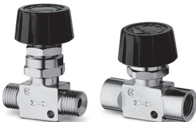
Sono valvole di regolazione bidirezionali costruite interamente in OT nichelato con guarnizioni in gomma NBR e volantino in tecnopolimero. Sono adatte alla regolazione di aria compressa o di acqua ad oli minerali.
