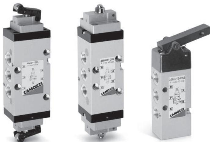
Il particolare dispositivo meccanico permette a queste valvole di fine corsa bassissime forze di azionamento. La Serie 3 è stata costruita con un dispositivo a leva meccanica che lavora in depressione e sulla quale si può applicare una prolunga in acciaio Ø3 per aumentare la sensibilità.
