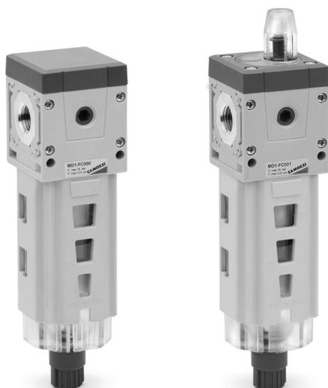
Il filtro a coalescenza è un disoleatore che rimuove le sostanze solide con dimensioni variabili da 0,1 a 5 µm e vapori di olio con una concentrazione da 0,01 a 0,1 mg/m³. Per un corretto funzionamento necessitano di un pre-filtraggio. Data la caratteristica di questo filtro è consigliabile sostituire l'elemento filtrante almeno ogni 12 mesi o 8000 ore di lavoro.
