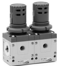
La versione Manifold consente di realizzare una batteria di regolatori alimentati da un'unica sorgente di pressione in ingresso. Ogni regolatore può essere impostato a un valore di pressione qualsiasi (inferiore a quella di ingresso). La connessione frontale o posteriore di ogni regolatore consente di prelevare l'aria al valore di pressione impostata sul regolatore stesso.
