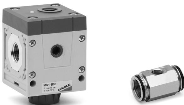
Il modulo di derivazione consente di prelevare aria dal gruppo di trattamento aria sia in posizione intermedia sia terminale. La stessa operazione, anche se in modo più limitato, può essere effettuata con la boccola intermedia.
