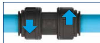
**Scollegamento,** ruotare il colletto di circa 1/4 di giro in senso orario. Bloccando in questo modo la pinzetta in posizione, si riduce il movimento assiale e radiale del tubo nel raccordo.
