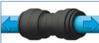
**Scollegamento,** assicurarsi che l'impianto sia depressurizzato. Spingere la pinzetta verso il raccordo e sfilare il tubo. Il raccordo può essere riutilizzato.
