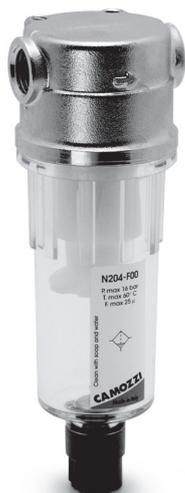
I filtri della Serie N sono disponibili con attacchi da G1/8 e G1/4. La tazza trasparente permette di vedere molto facilmente i livelli della condensa, ed è dotata di scaricatore manuale e semiautomatico. Sono disponibili modelli con tre diversi gradi di filtraggio: 25µm, 5µm e 0,01µm.
