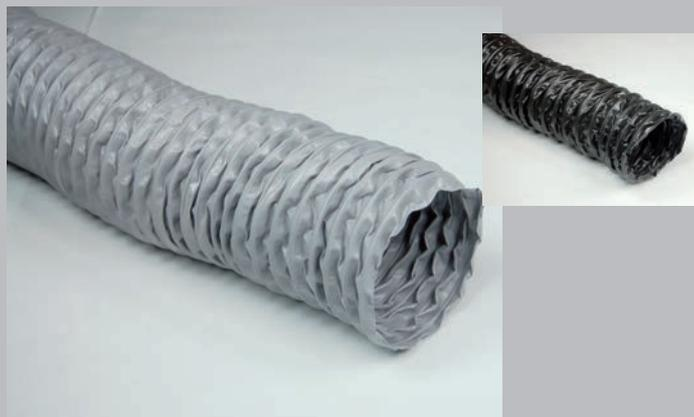
Tubo flessibile realizzato con tessuto in poliamide spalmato di PVC sui due lati e spirale incorporata in filo armonico. La speciale esecuzione consente l'impiego in tutte le installazioni di aspirazione e ventilazione dell'aria anche con parti in movimento.
