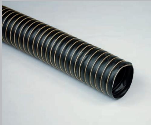
Tubo flessibile realizzato con uno strato di tessuto in fibra di vetro spalmato di neoprene, spirale interna e visibile in acciaio armonico ramato, cordoncino esterno in fibra di vetro.
