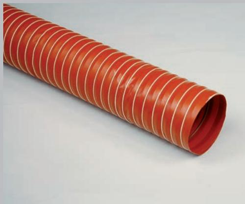
Tubo flessibile realizzato con uno strato di tessuto in fibra di vetro spalmato di silicone, spirale interna e visibile in acciaio armonico ramato, cordoncino esterno in fibra di vetro.
