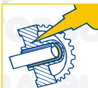
Gli adesivi di questa linea permettono il montaggio ad **alta resistenza** di un accoppiamento cilindrico quale: cuscinetti, ingranaggi, pulegge, perni, boccole. Garantiscono un'alta coppia di trasmissione. **Sostituiscono** chiavette, alberi scanalati, saldature **Sigillano** il giunto eliminando la corrosione da agenti esterni e da contatto. Possono incollare materiali diversi tra loro. Resistono ad **alte temperature** (sino a 230°C)
