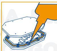
Per **sigillare** accoppiamenti piani e giunzioni flangiate di pompe, scatole di ingranaggi, cambi, differenziali, motori. Sostituiscono le guarnizioni preformate, **garantiscono la sigillatura** con tolleranze di lavorazione di alcuni decimi di mm, consentono il contatto metallo-metallo evitando l'allentamento dei bulloni nel tempo. Formano una guarnizione flessibile e/o elastica **resistente a vibrazioni, calore, olii e fluidi industriali**. Sono smontabili con normali utensili.
